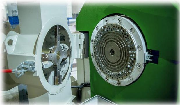
**Гранулятор** – специальное оборудование, на котором расплавленное сырье выдавливается через насадку в форме «колбаски» и при воздействии высоких температур режется ножами на гранулы..
