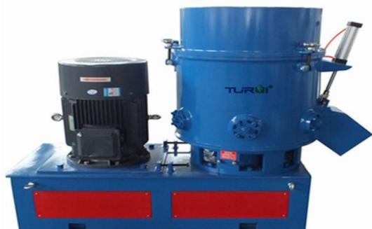
**Агломератор** – это специальное оборудование, которое используется при измельчении пластика.
